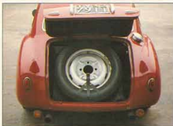
Dall'alto in basso e da sinistra a destra. Le due bocchette cromate ovali e la maniglia esterna. I cerchi anteriore e posteriore a disco speciale Giannetti; da notare il mozzo posteriore fuso col ponte De Dion. Il sistema di apertura del baule e il bocchettone a riempimento rapido del serbatoio del carburante. Sotto il cofano posteriore c'è posto solo per il serbatoio e per la ruota di scorta. Il motore, n. 1815, installato sul telaio n. 189.
